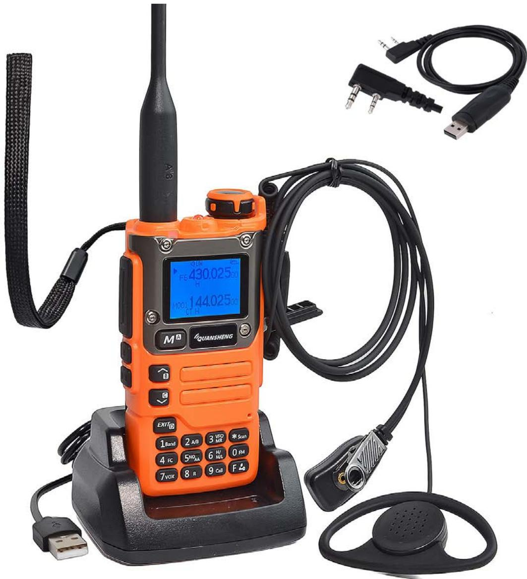
**Photo d'un UVK5 de couleur avec son chargeur, antenne, écouteur, micro et câble de programmation.**
